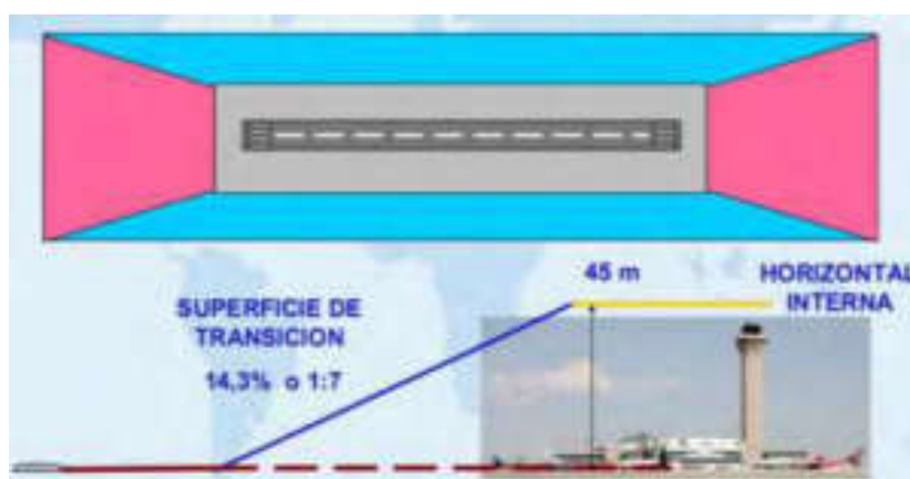
Figura 39 – Superfície Horizontal Interna Fonte: OACI (2009)
