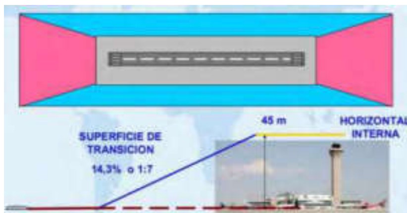
Figura 39 – Superfície Horizontal Interna Fonte: OACI (2009)
