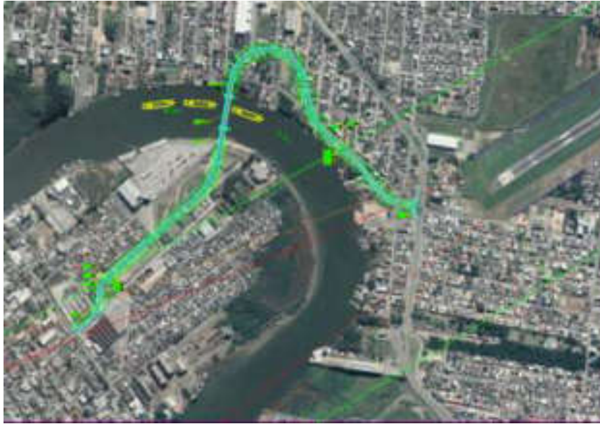
Figura 45 – Superfícies PBZPA e Projeto da Ponte Fonte: Adaptado de Mira (2015 apud. INFRAERO, 2015)
