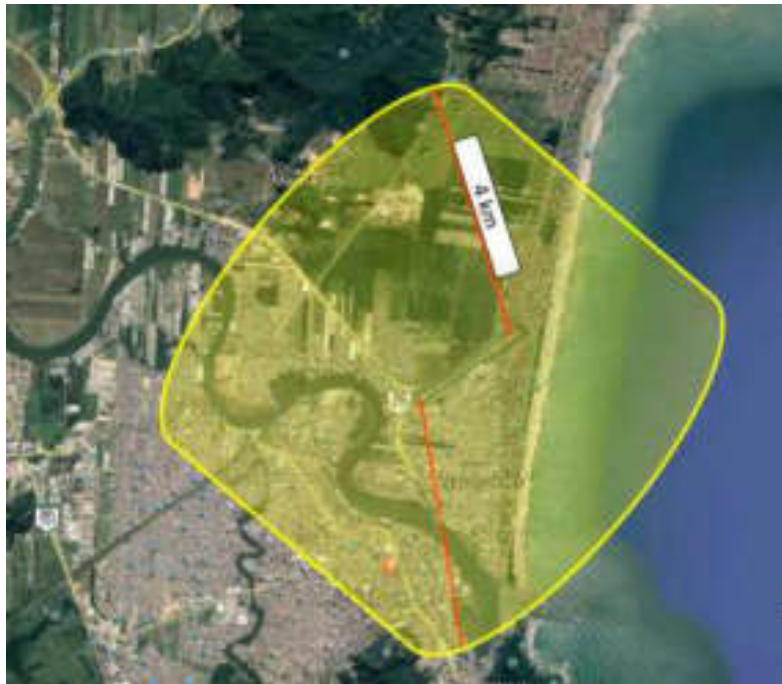
Figura 38 – Superfície Horizontal Interna Fonte: Elaboração Própria
