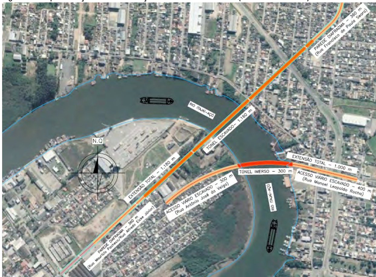
Figura 10: Representação das duas soluções de travessia em túnel (escavado e imerso).
