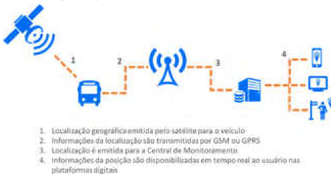
Figura 63 – Esquema ilustrativo do funcionamento do sistema de monitoramento por GPS
