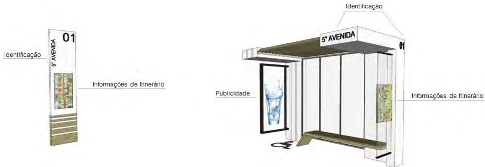
Figura 32 - Estrutura física dos pontos de ônibus
