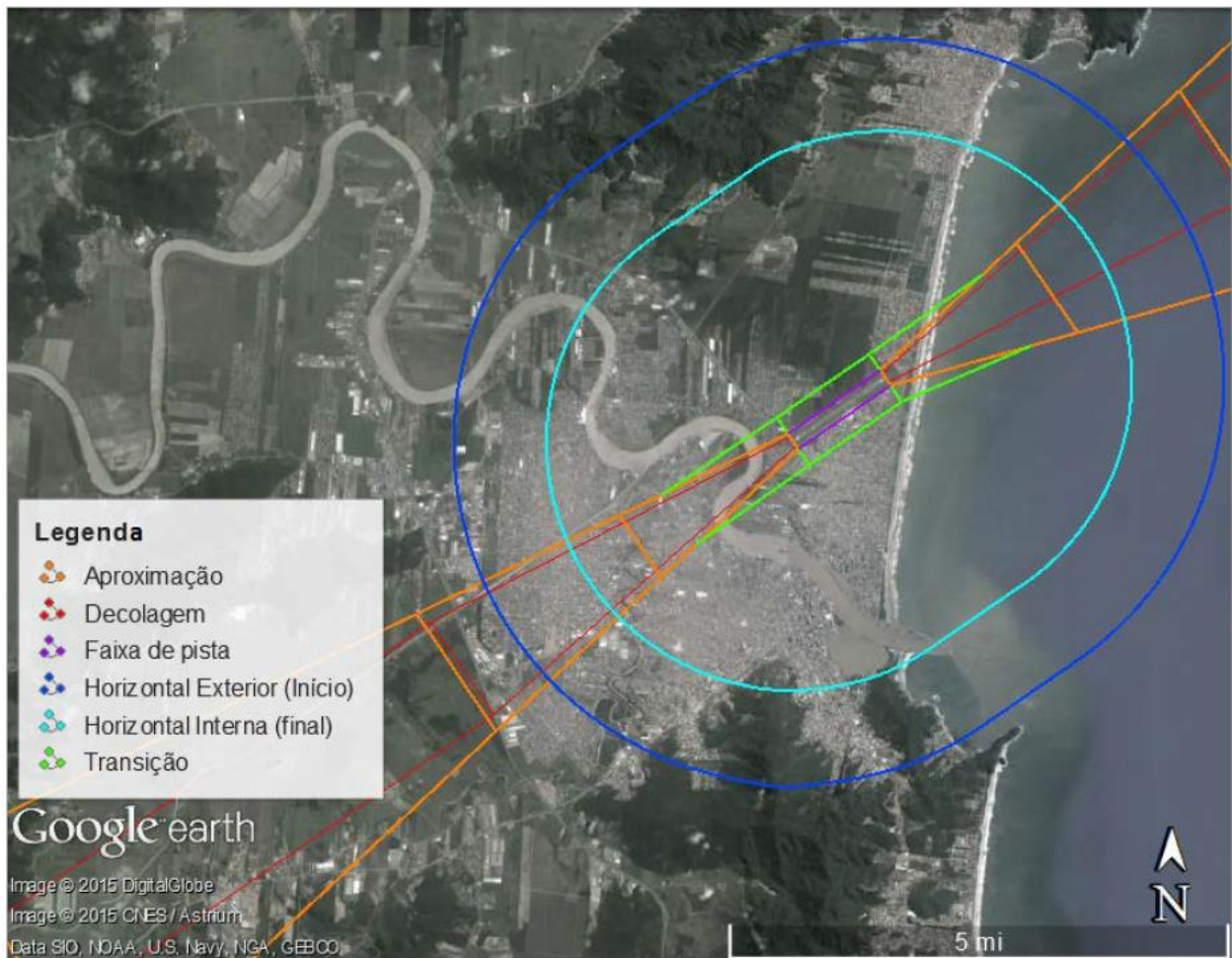
Figura 38 – Superfícies PBZPA Fonte: Mira (2015 apud. INFRAERO, 2015)
